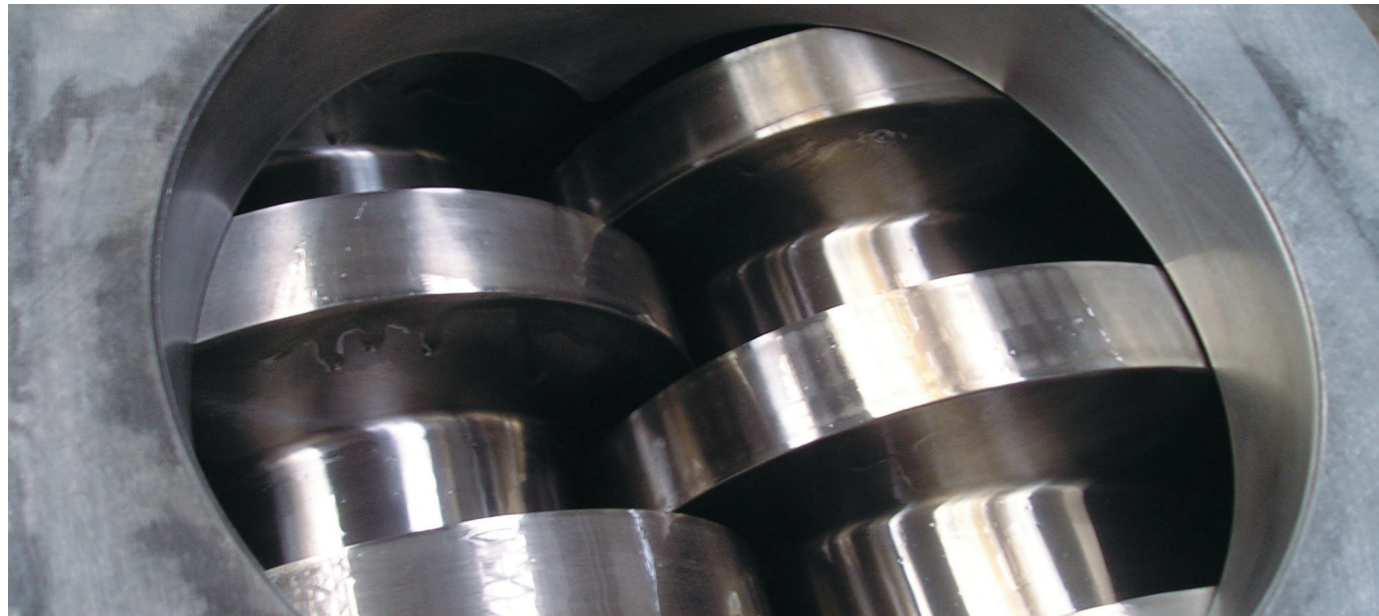
Ślimaki zazębiające się stożkowo (skomplikowane rozwiązanie techn. w maszynie)
