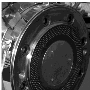
Пластина для горячего гранулирования
