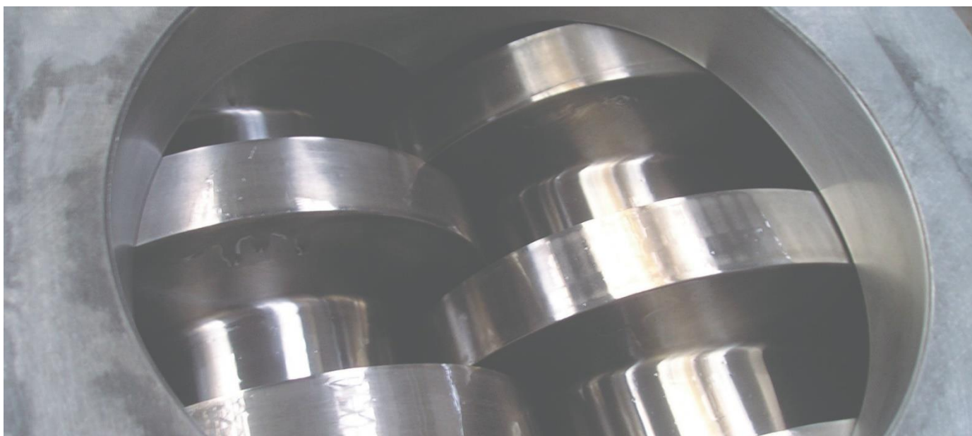
Шнеки с коническим зацеплением (сложное техническое решение в машине)
