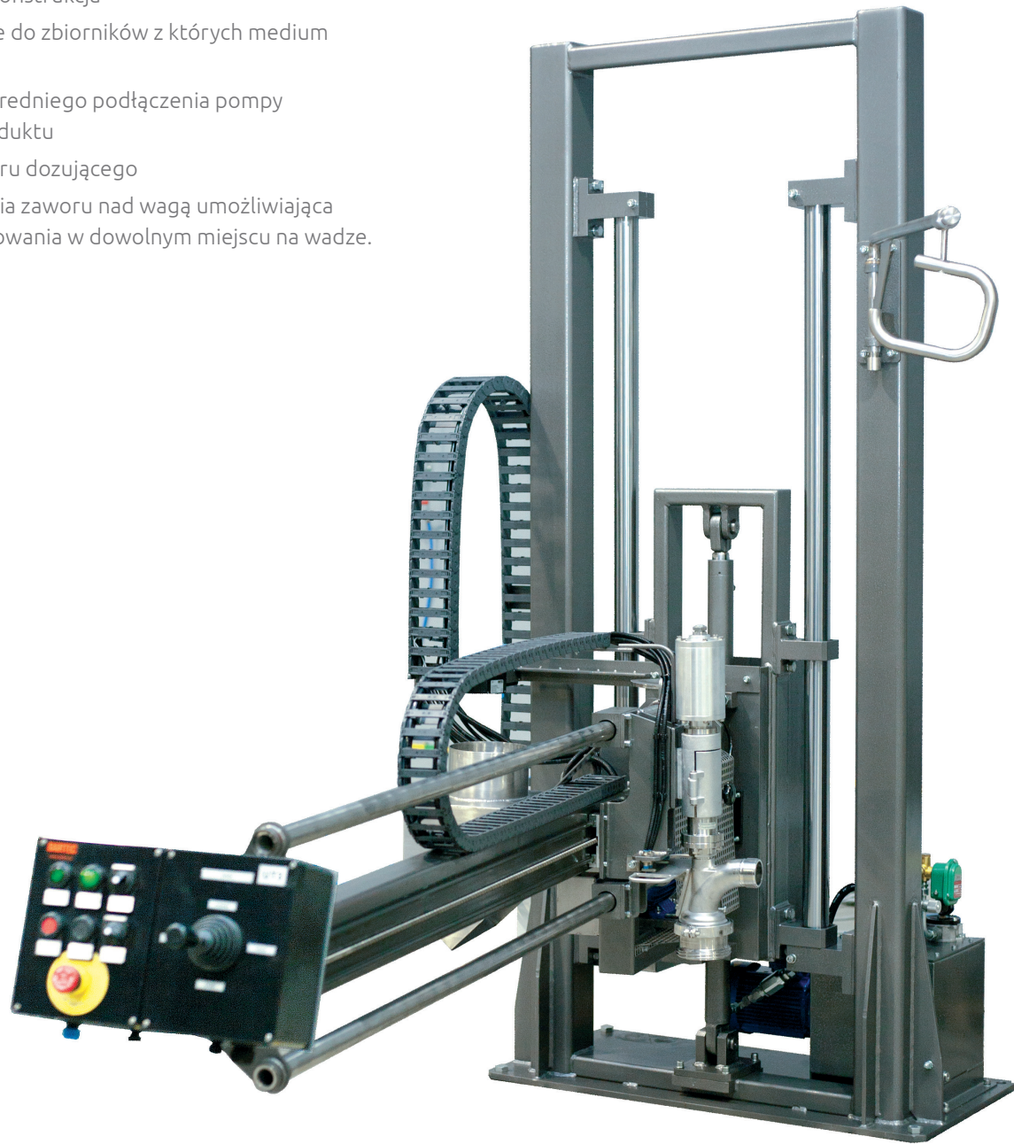
DANE TECHNICZNE: Rozlewaczka wagowa półautomatyczna do beczek PFD_G
